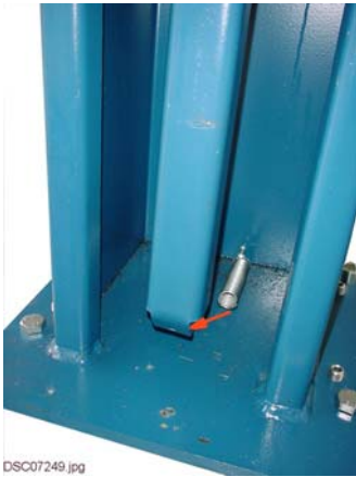
Bild 6: Zugfedern an den Klinkenleisten einhängen
