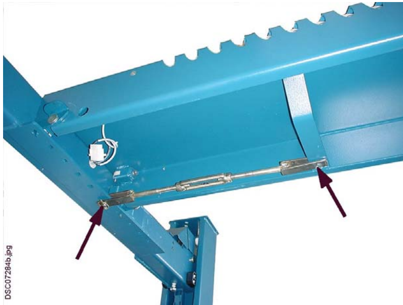
Bild 7: 2 Spannschlösser werden an der verstellbaren Fahrschiene montiert und mit der Hand angezogen.
