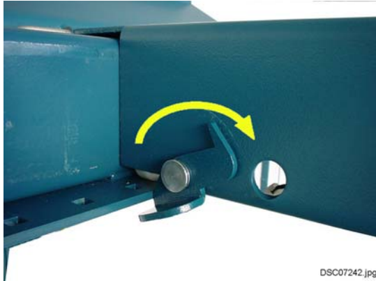
Bild 2: Verstellbare Auffahrschiene entriegeln
