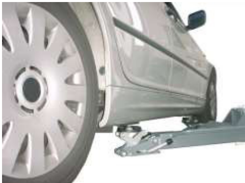
Immagine 1: Posizionare i piatti portanti solo sotto i punti di sollevamento autorizzati dal produttore.
