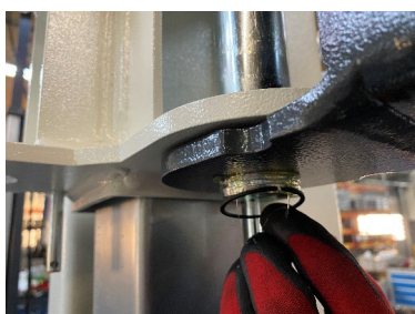
Colocar el anillo de seguridad inferior
