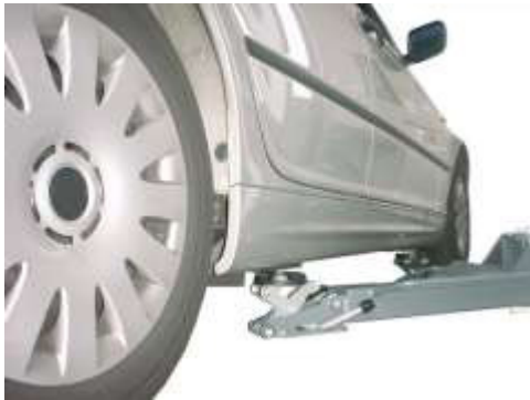
Figure 1 : Positionner des plateaux porteurs sous les points de levage requis par le constructeur du véhicule.
