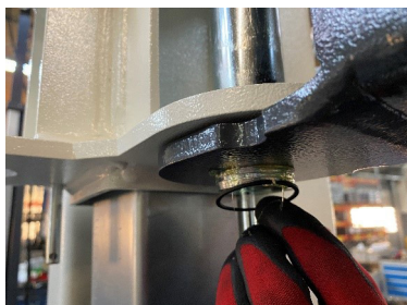
Montare l'anello di sicurezza nella parte inferiore
