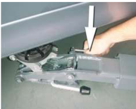
Bild 3: Um die Aufnahmeteller zu entriegeln muss der hintere Hebel gedrückt werden.
