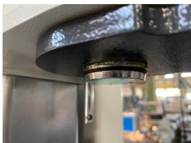
Fissaggio inferiore del bullone del braccio portante
