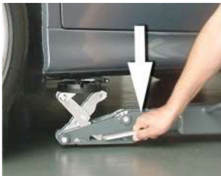
Figure 2 : Le cas échéant, positionner les plateaux porteurs sous les points de levage en appuyant sur le levier.
