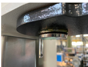
Seguridad inferior del perno del brazo portante
