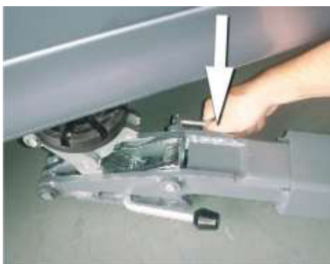
Immagine 3: Per sbloccare i piatti di alloggiamento bisogna premere la leva inferiore.
