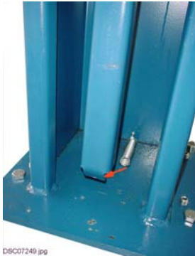
Bild 5: Zugfedern an den Klinkenleisten einhängen
