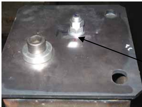
Bild 3: Sicherung des Seils an der Säulenkopfplatte mit 2 Muttern M12 DIN934 (hier Beispiel für eine Säule)
