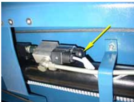
Bild 2: Doppelsitzventil mit Handbetätigung am Zylinder
