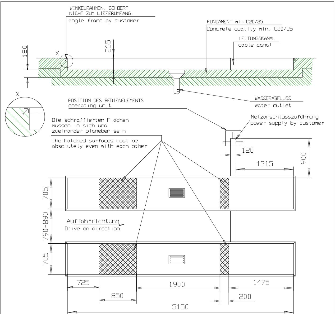
Achtung: Gilt nur für die Serienausführung mit Stellplatten und beidseitigen Auffahrklappen. Anstelle des Leitungskanals kann auch ein Leerrohr  $\varnothing$  100 verlegt werden.
