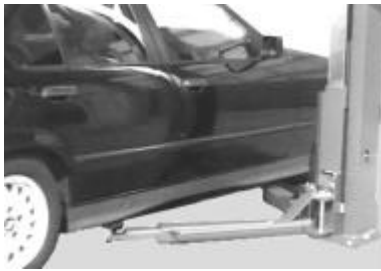
Fig. 1: Colocar los tacos de goma en los puntos de apoyo previstos por el fabricante del vehículo.
