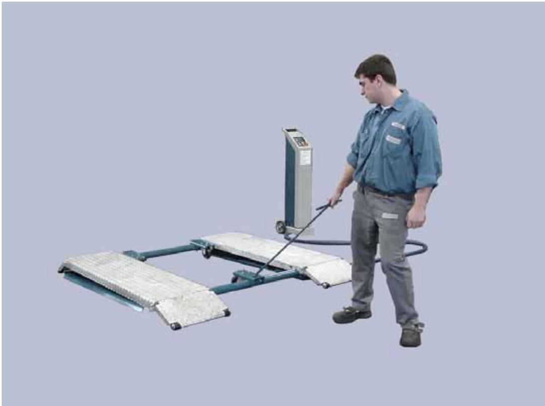
Danach die Hebebühne komplett absenken. Deichsel einhängen und die Hebebühne kann verschoben werden.
